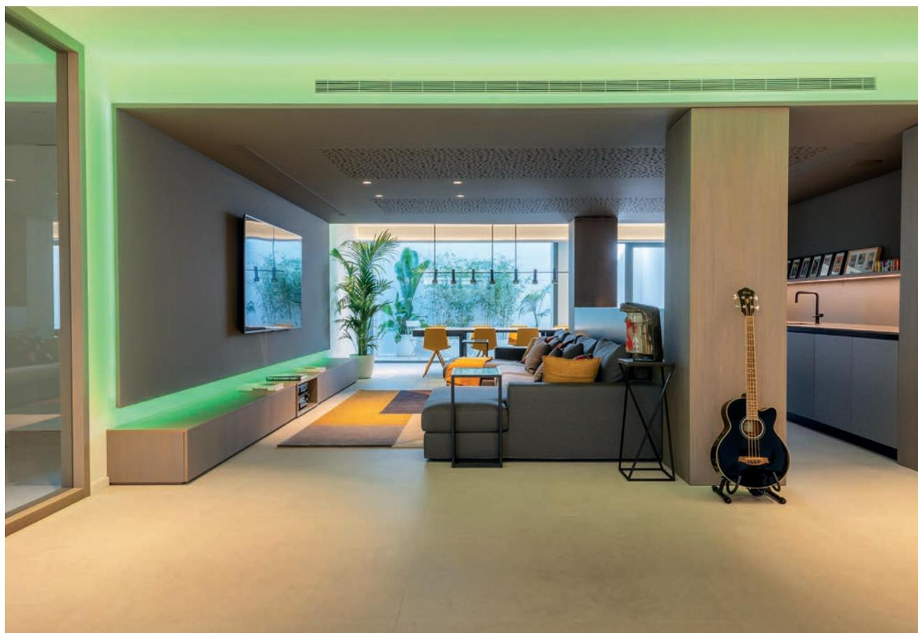
**El techo es un gran panel retroiluminado con tiras RGB que cambian de color en función de la escena deseada. Este techo baja por la pared siguiendo el mismo criterio y sirve para suspender la pantalla. Bajo ésta, un mueble diseñado en la misma madera que el resto de la casa diseñado por**
